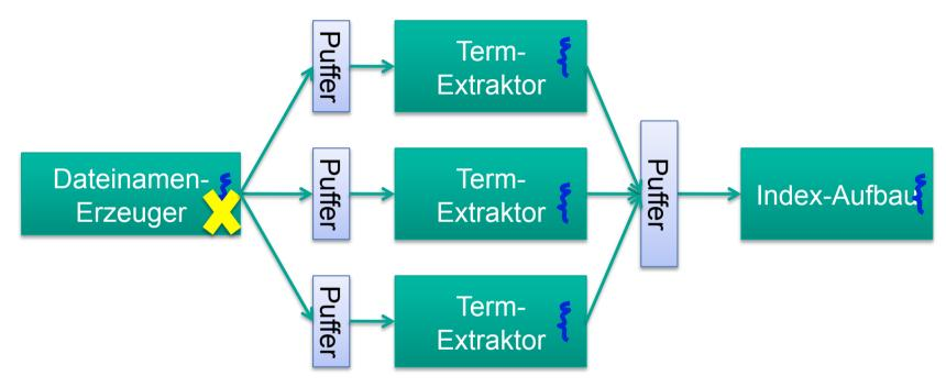
Dateinamen-Erzeuger läuft allein, ohne andere Fäden, und speichert die Ergebnisse komplett in den Puffern der Extraktoren ab (im Umlaufverfahren). Damit dort keine Synchronisation nötig.
