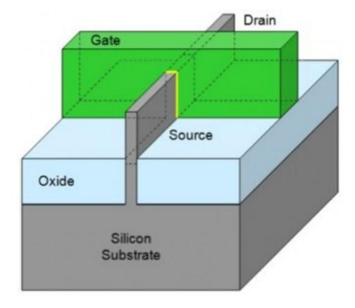
Das Gatter umgibt den Kanal von drei Seiten. Dadurch verringerte Leckströme, niedrigere Spannung, höhere Frequenzen, kleinere Abmessungen.
