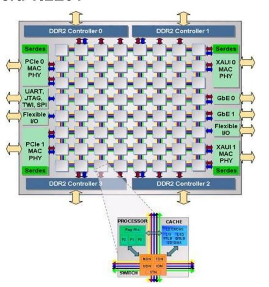
64 VLIW Prozessoren plus Gitter auf einem Chip
