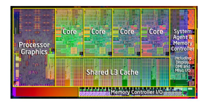
2011: 4 CPUs, 12 graphische Ausführungseinheiten, 32 nm
