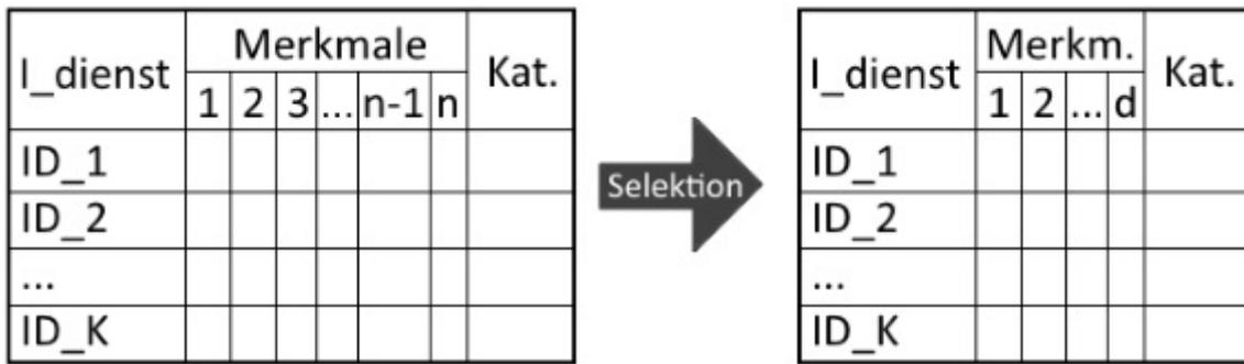
Abbildung 4.5.: Merkmalsselektion: Die Merkmalsselektion entfernt redundanten und irrelevanten Merkmale.
